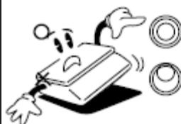
Éloignez la balance d'autres appareils électromagnétiques. Cela risquerait d'altérer la précision des relevés.
